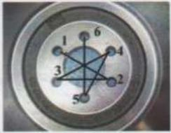
Couple de serrage - Tightening torque - Anzugsdrehmoment
